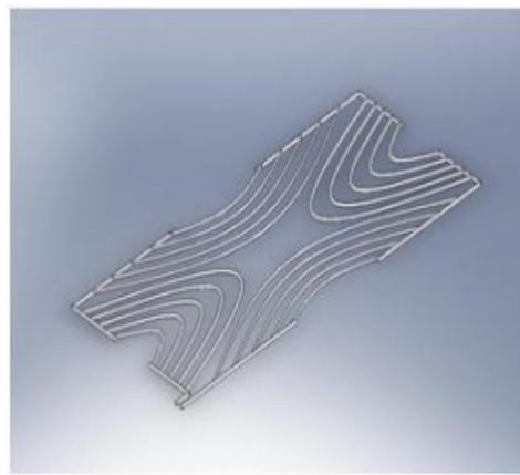
Fig. 11. Parallel-Serpentine Flow Design
