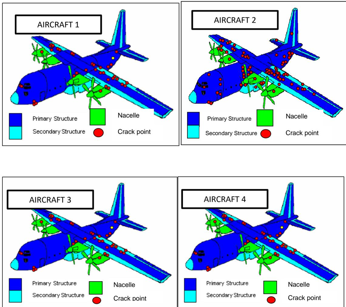
Fig. 8. Crack Mapping
