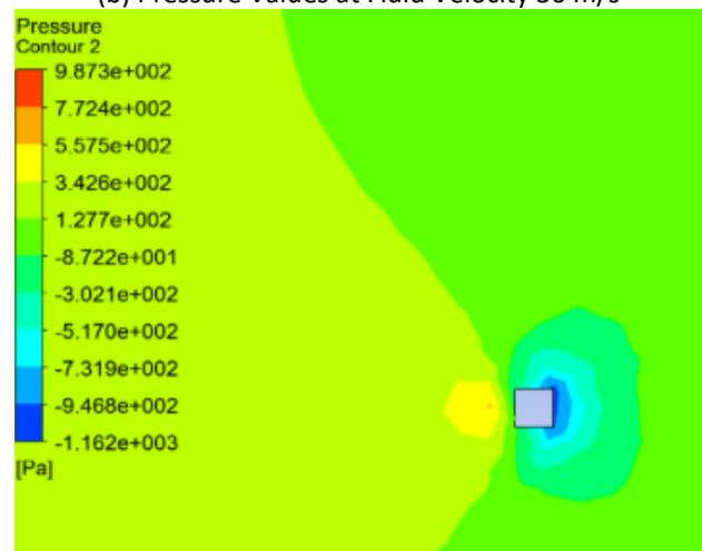
(d) Pressure Values at Fluid Velocity 50 m/s
