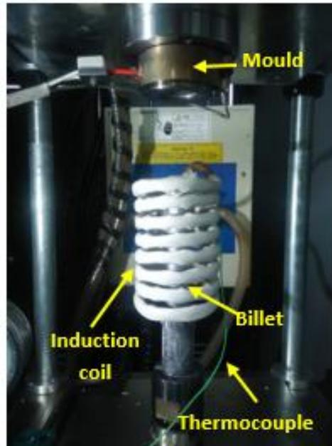
Fig. 2. Thixoforming setup
